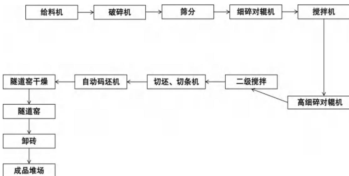
图1 烧结砖生产工艺流程
